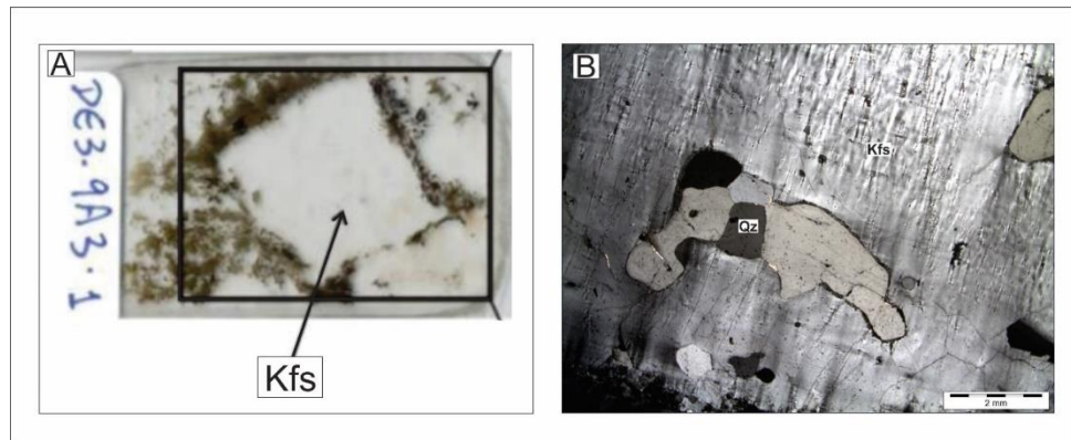
Figura 13. A) Cristal de feldespato potásico rodeado de selvedge biotítico; DE3-9A3-1. B) Relicto de la roca hospedante inclusos en el feldespato potásico; DE3-5A1-2, polarizadores cruzados.
