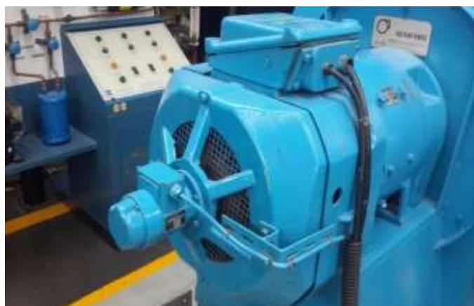
Figura 10. Ventilador centrífugo Solyvent Ventec- Motor UNELEC 15.4 kW.
