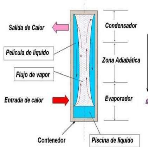
Figura 1. Estructura general de un TTB. Adaptado de Faghri (1995). Estudio analítico-experimental de operación de un tubo termosifón bifásico TTB.
