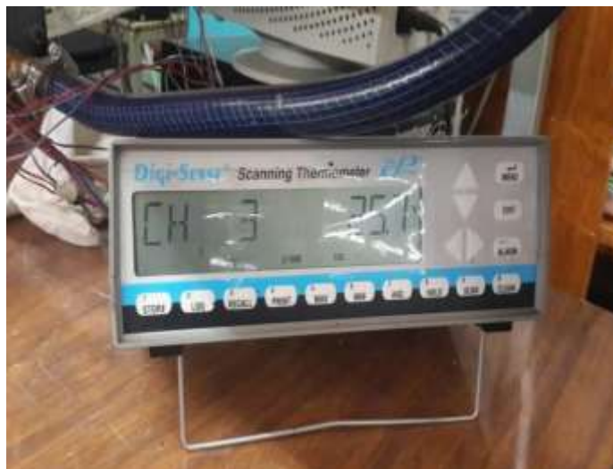
Figura 17. Escáner de termocuplas Digi-sense, Cole Parmer de 12 canales modelo 92000-00.
