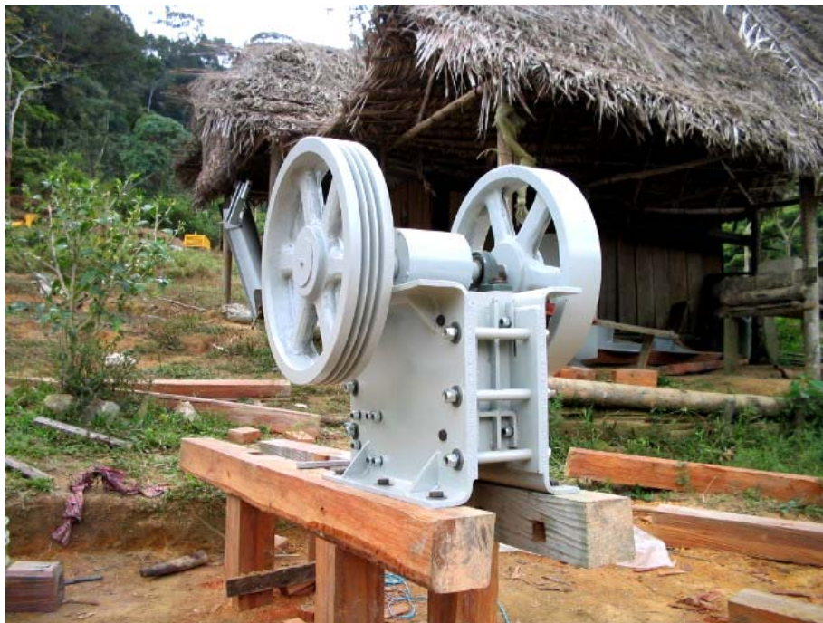
Figura 51. Estructura de soporte y anclaje.
