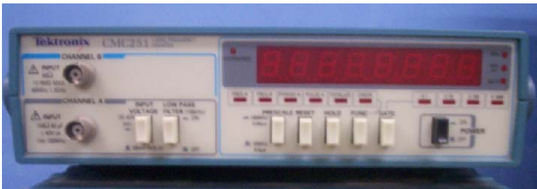
Figura 20. Frecuencímetro: Contador TEKTRONIX CMC251
