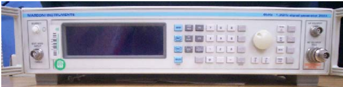
Figura 17. Generador de señal: Marconi Instruments - sg2023
