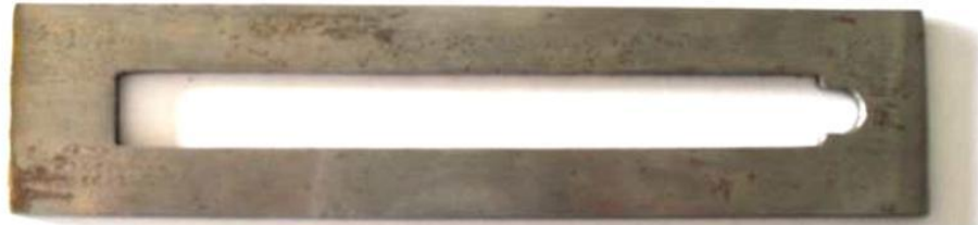
Molde probeta de Flexión Ancho:12,7mm Largo:127mm Espesor: 3,2mm
