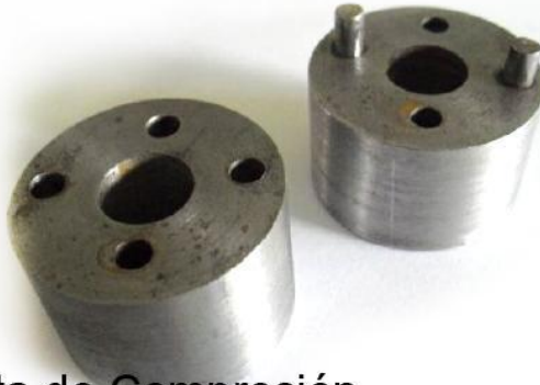
Molde probeta de Compresión Diámetro:12,7mm Largo: 25,4mm
