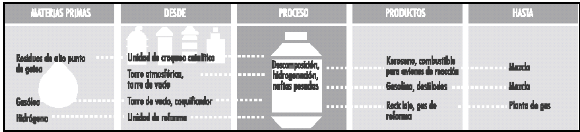
Figura 38. Proceso de hidrocrackeo
