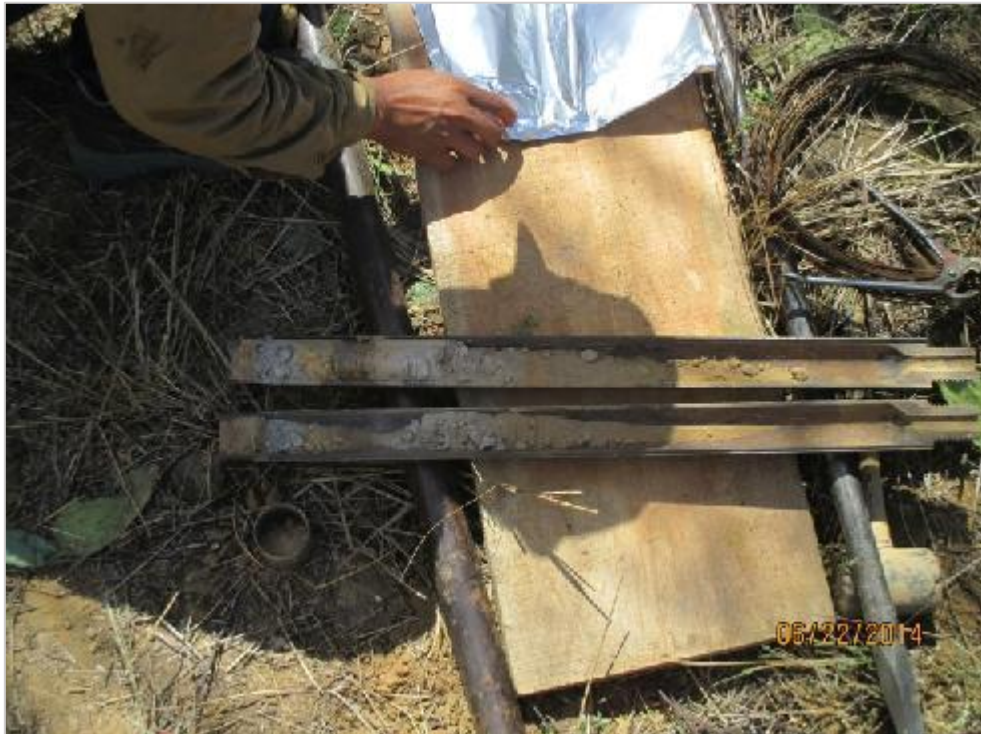
Fotografía 1. Muestreador del ensayo de penetración estándar SPT.
