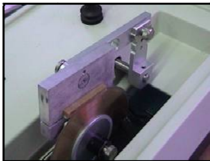
Figura 46. Elemento para cortar el ancho de la muestra
