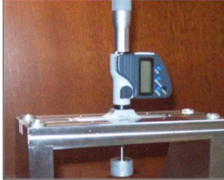
Figura 114. Micrómetro instalado – acople celda de carga con micrómetro
