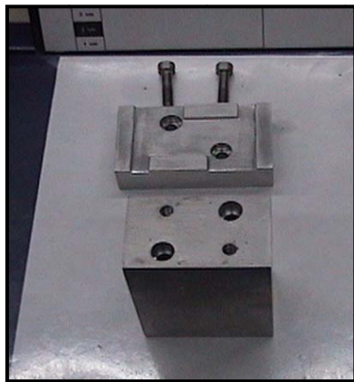
Figura 41. Elemento para pulir y reducir espesor de la muestra
