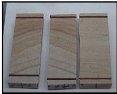
Figura 44. Líneas de corte marcadas sobre la muestra.
