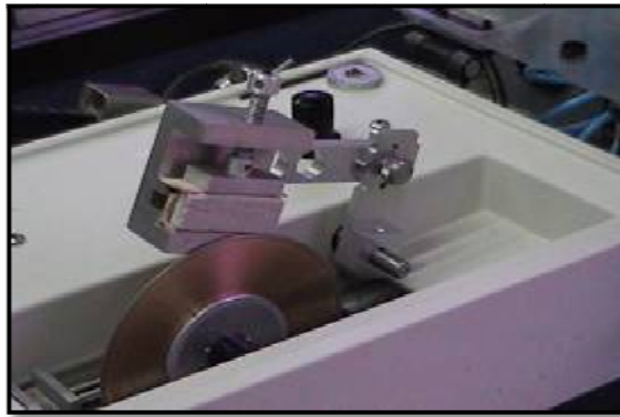
Figura 47. Montaje del elemento para reducir el espesor de la muestra
