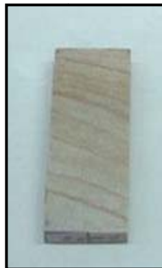
Figura 36. Secciones rocas extraídas del plug de (70mmx30mmx12mm)
