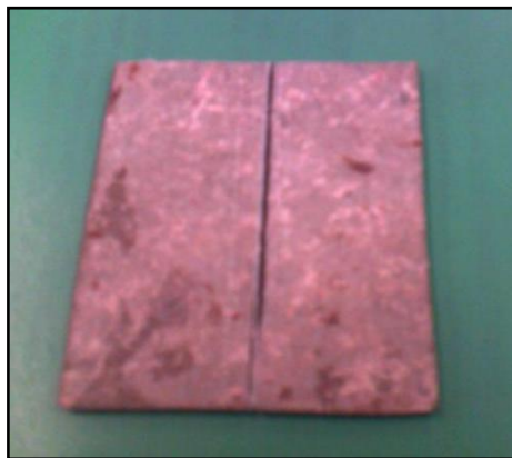
Figura 8. Probeta de ensayo para calcular la fuerza de fracturamiento.
