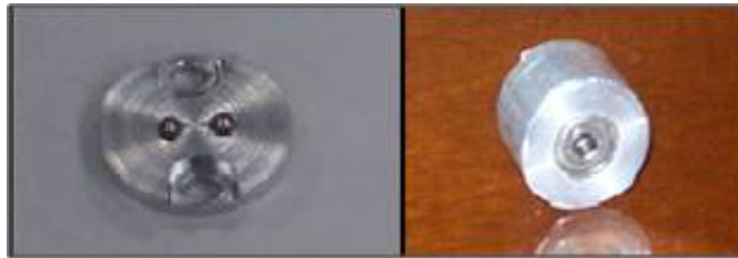
Figura 29. Acople celda de carga y dispositivo de presión.
