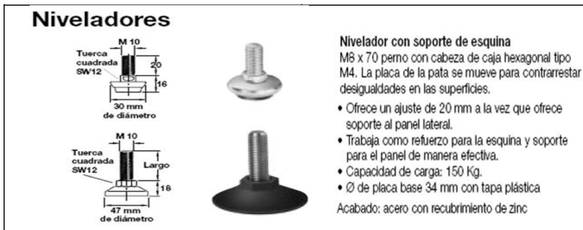
Figura 19. Características del tornillo nivelador - catalogo "HAFELE"
