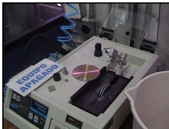
Figura 32. Sierra de precisión ISOMET 1000.
