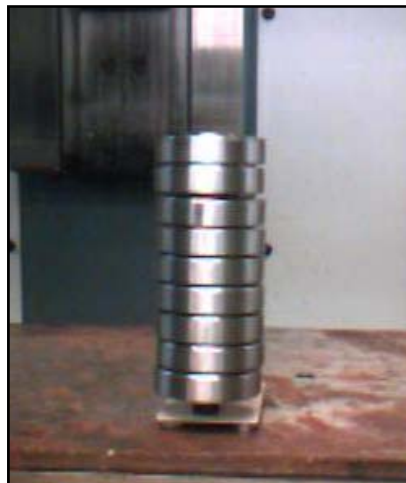
Figura 7. Montaje de la Prueba de Doble Torsión
