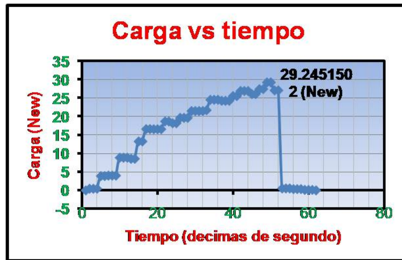
Figura 88. Grafica Carga vs tiempo, prueba N°2
