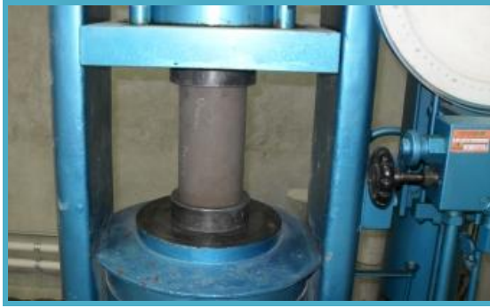
b) Disposición de la probeta para la prueba de compresión.
