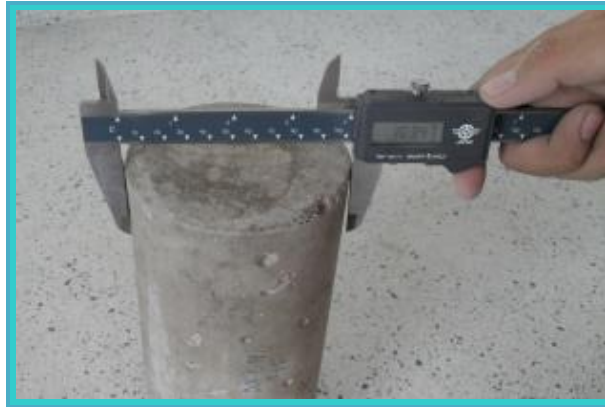
Figura 14. Determinación del diámetro de las probetas.
