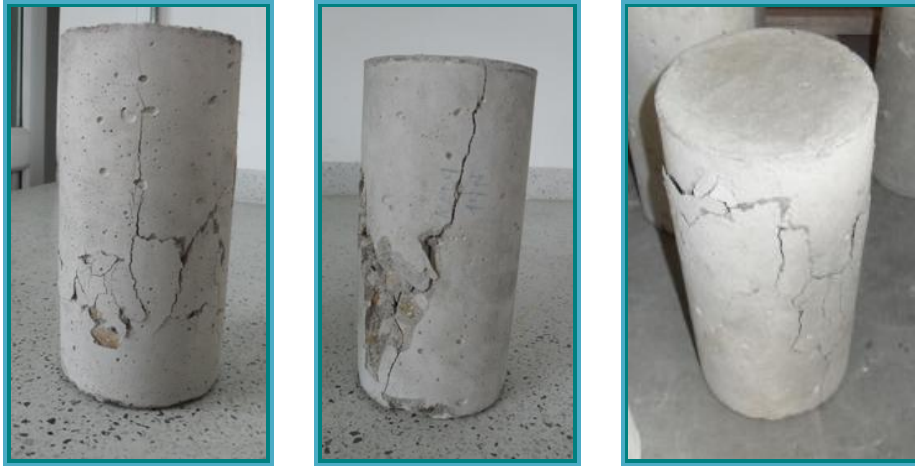
Figura 18. Falla presentada por las probetas después de realizar la prueba de compresión.
