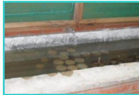
b) Proceso de curado realizado bajo condiciones (100% Humedad y temperatura ambiente)
