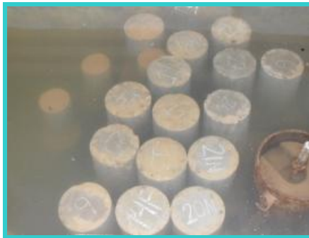
b) Proceso de curado realizado bajo condiciones (100% Humedad y temperatura ambiente)
