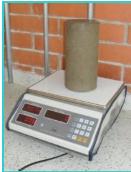
Figura 13. Pesado de las probetas
