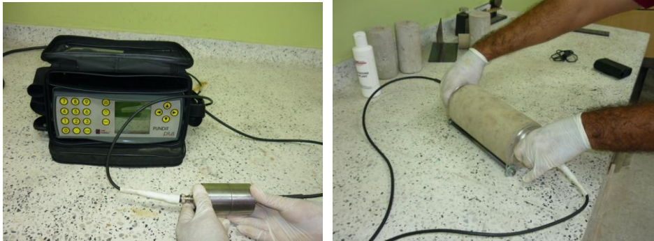
b) Calibración del equipo y prueba de ultrasonido
