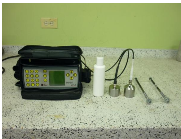
a) Equipo de ultrasonido MODEL PC 1006 tipo PUNDIT PLUS marca CNS FARNELL LTDA
