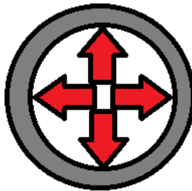
Figura 8. Diagrama de presión de estallido en el casing
