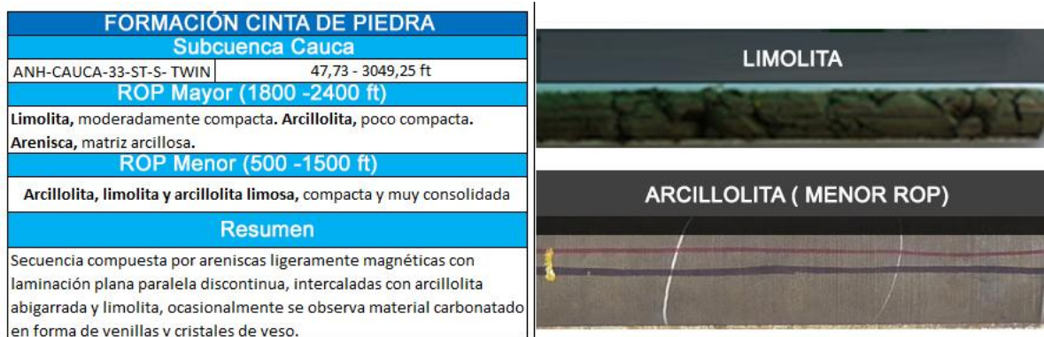
Figura 67. ROP en la formación Cinta de piedra, con base en el pozo ANH-CAUCA 33-ST-S-TWIN
