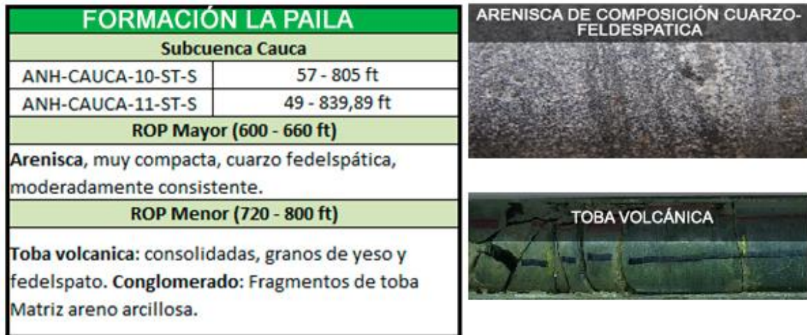
Figura 66. ROP en la formación La Paila, con base en el pozo ANH –CAUCA 10-ST-S.
