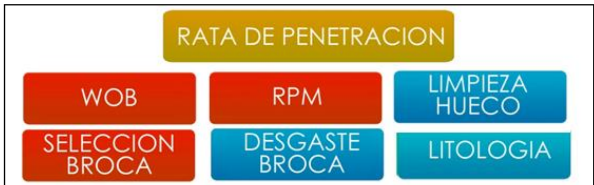
Figura 8. Factores que afectan la tasa de penetración
