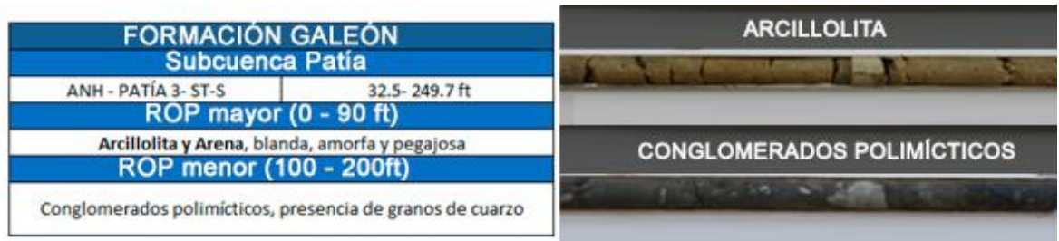
Figura 70. ROP en la formación Galeón, con base en el pozo ANH-PATÍA-3-ST-S.
