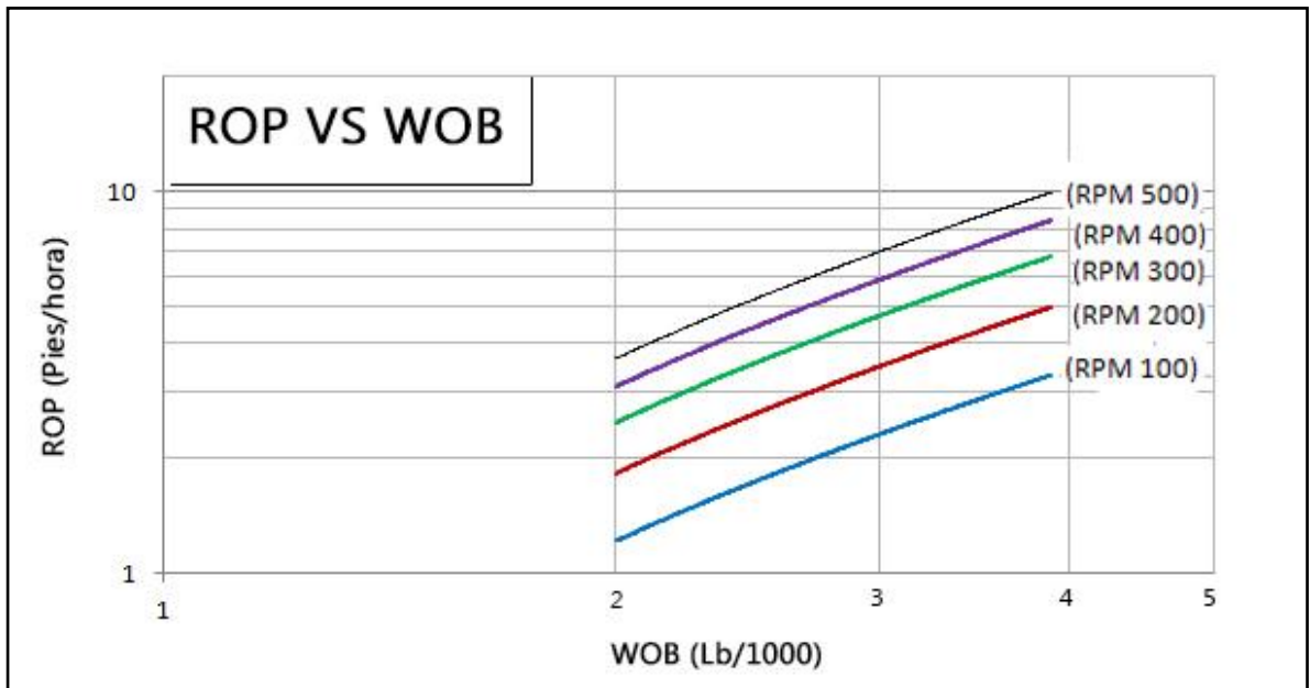
Figura 85. Tendencia del ROP VS WOB para la formación Cinta de Piedra.
