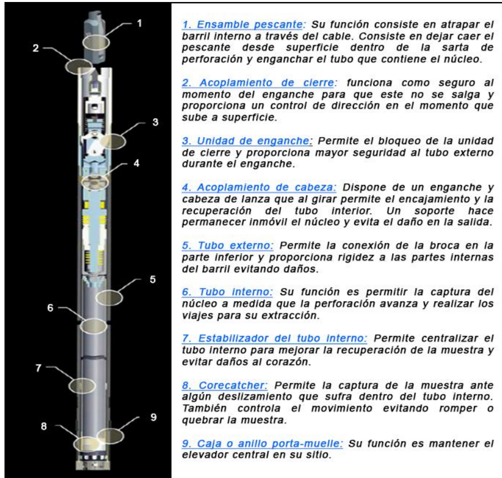
Figura 33. Partes del barril de corazonamiento con wireline
