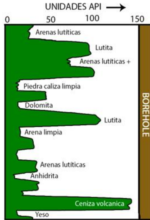
Figura 21. Respuesta común de las curvas de registro gamma ray
