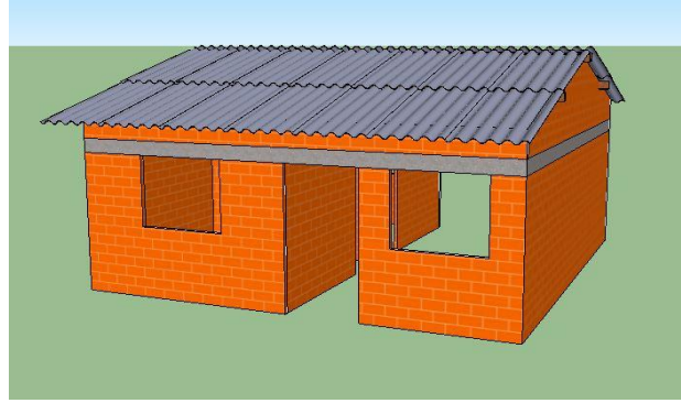
Figura 4. Vivienda Tipo en mampostería no reforzada.
