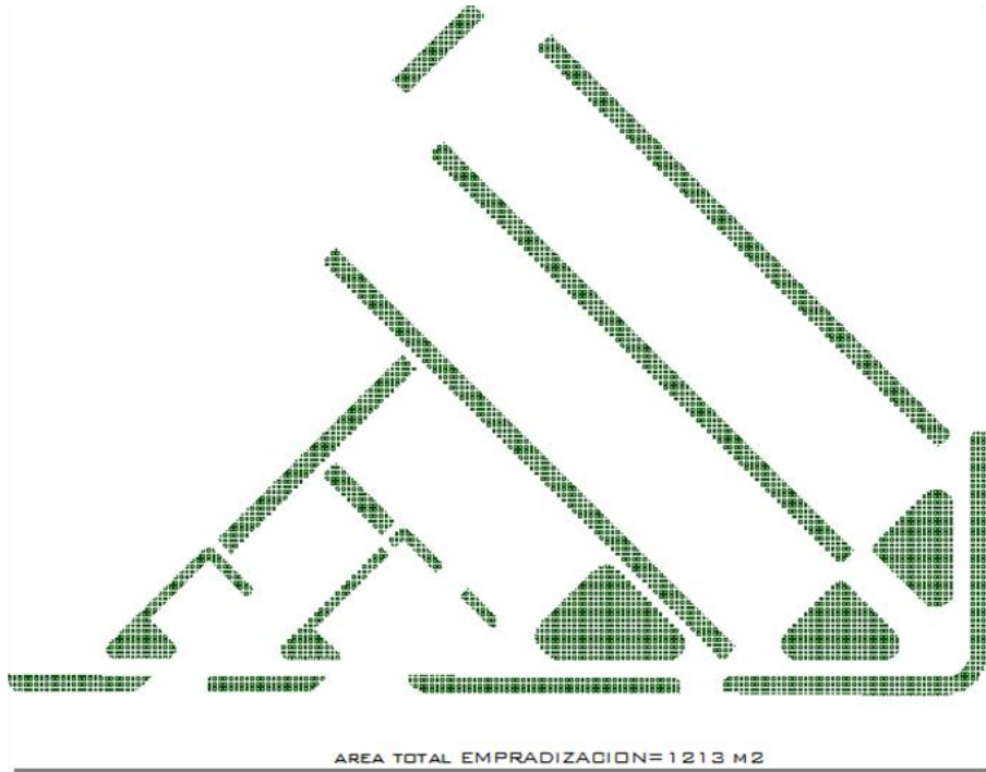
Fig. Nº 21 Ejemplo de obtención de cantidades de obra con software AutoCAD (empradizacion etapa 5). Fuente El Autor.
