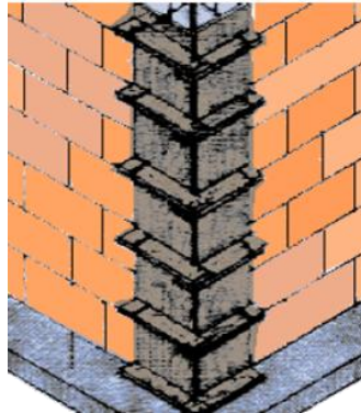
Detalle formaleta columna esquinera
