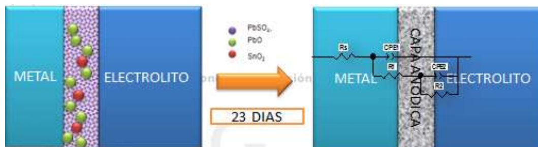
Figura 22: Formación de la capa anódica para 30 días de inmersión
