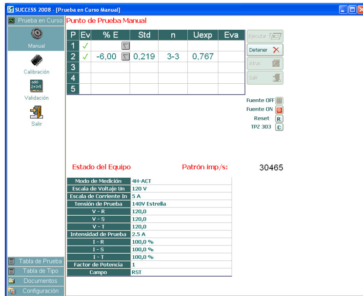
Figura 32. Resultados de la prueba con carga sinusoidal balanceada y corriente al 50% del valor nominal.
