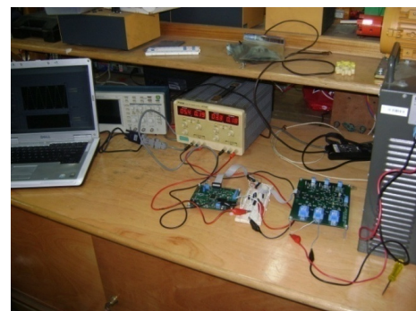
Figura 25. Montaje utilizado en el laboratorio de máquinas con el que se probaron los canales de tensión de la tarjeta
