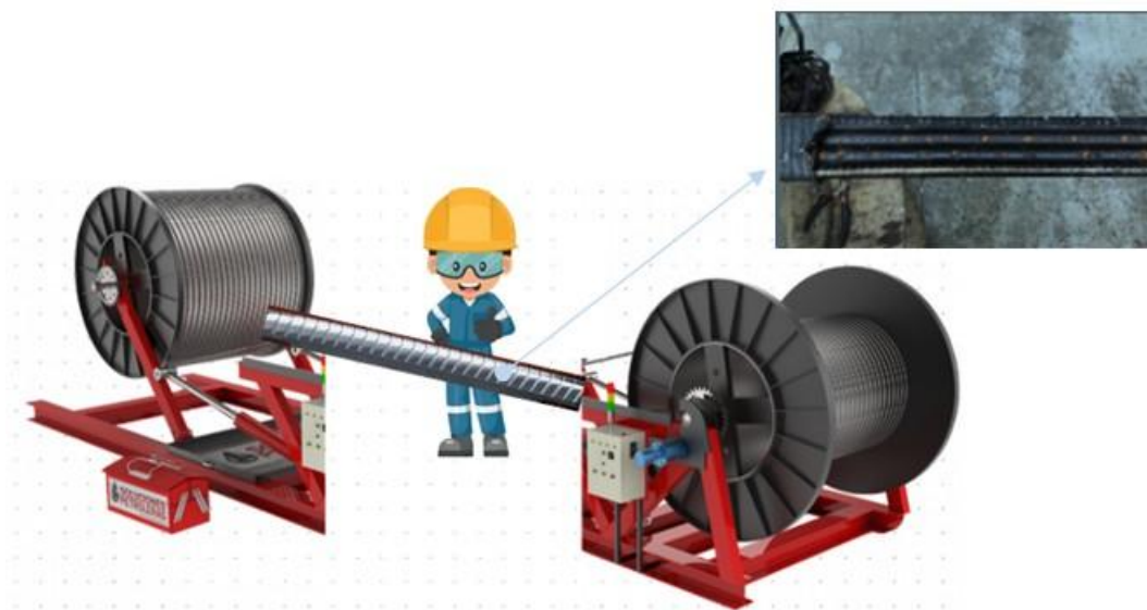
Figura 9. Proceso ilustrativo de remoción de armadura
