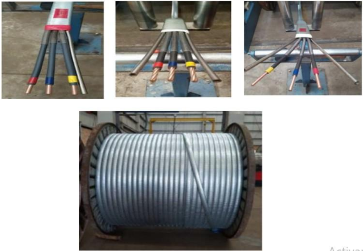
Figura 13. Registros fotográficos de cable BES después de proceso de rehabilitación.
