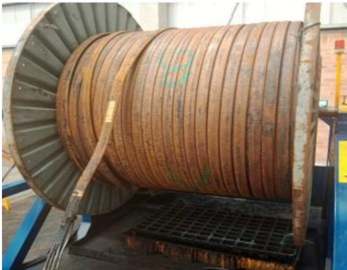
Figura 6. Cable de potencia BES en condición de corrosión
