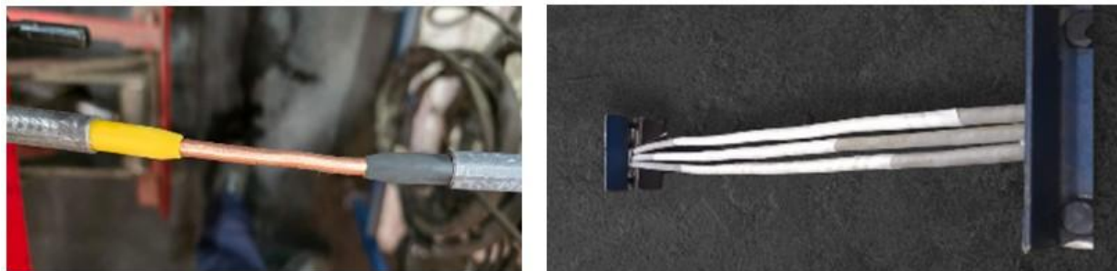
Figura 3. Empalme invisible con Nicopress.
