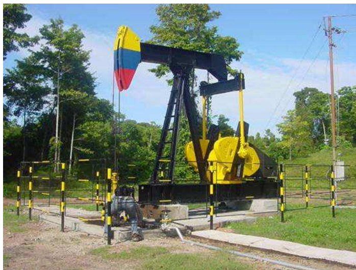
Figura 4. Pozo de extracción
