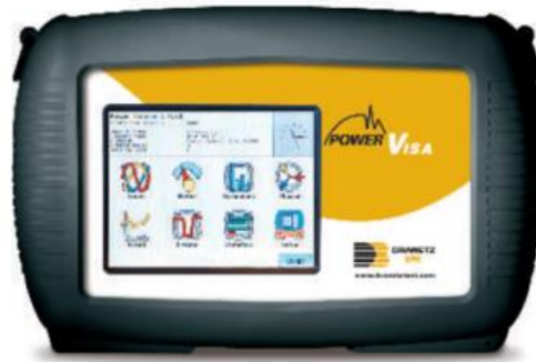
Figura 35: Analizador de redes Power Visa 440
