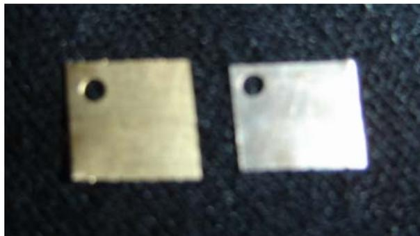
**(a) Probeta de oro    (b) Probeta de plata**
