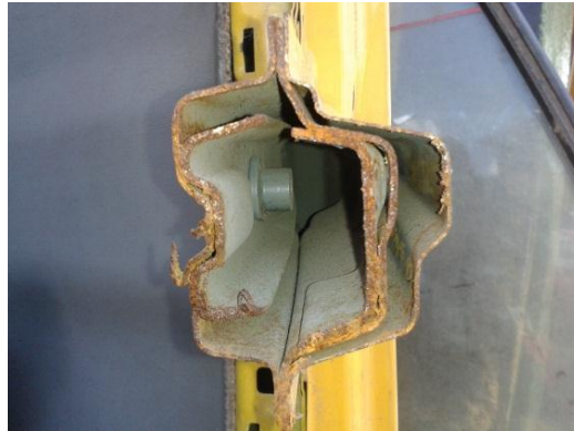
Figura 52. Imagen de sección de un montante de un HYUNDAI ACCENT.
