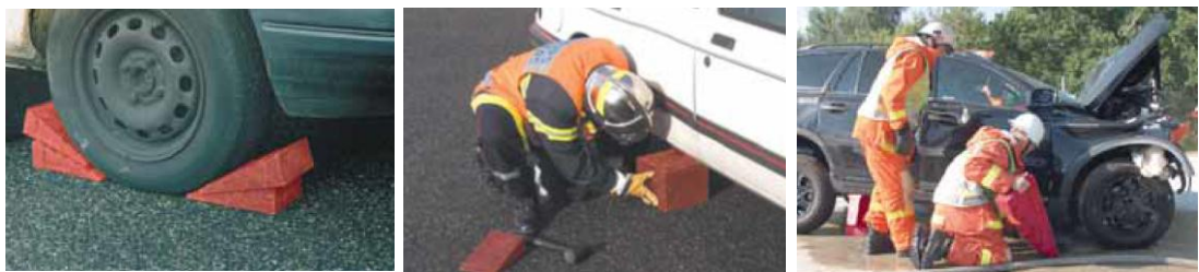
Figura 30. Estabilización del vehículo.
