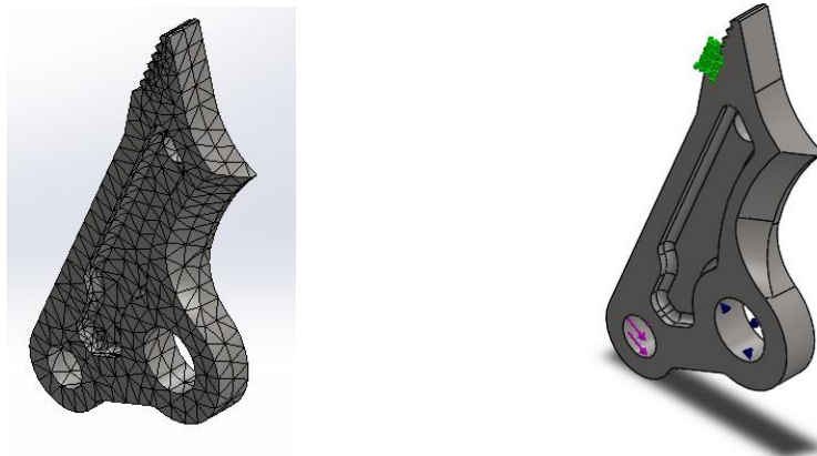
Figura 233. Malla y ubicación de cargas y apoyos, quijada en estudio 3.
