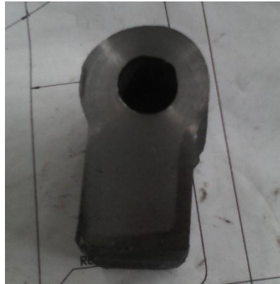
Figura 246. Empalme después del proceso de oxicorte.
