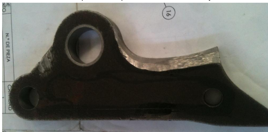
Figura 242. Herramienta después del proceso de oxicorte y taladrados.
