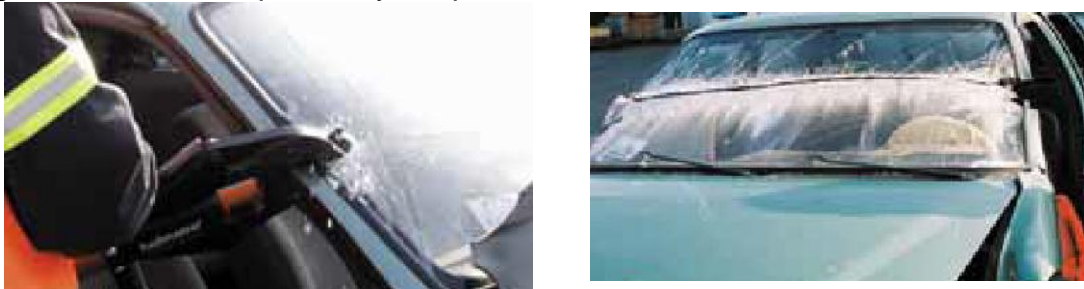
Figura 45. Corte del poste A y del parabrisas.
