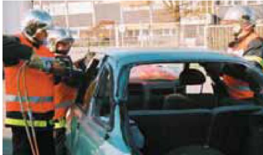
Figura 46. Corte de los postes B y C.
