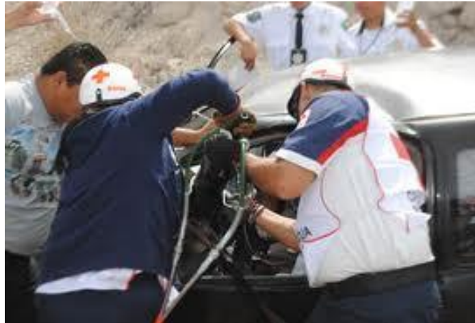
Figura 7. Uso de la herramienta mixta para separar las bisagras de las puertas del vehículo.
