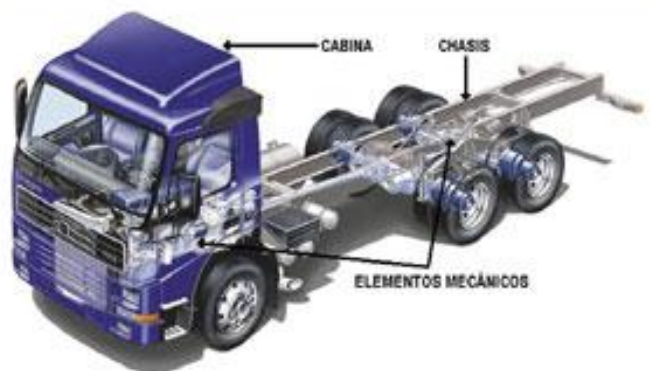
Figura 22. Partes principales de un camión.
