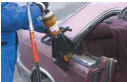
Figura 43. Retirada del panel.
