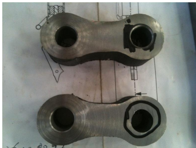
Figura 245. Bielas después del proceso de oxicorte y taladrados.
