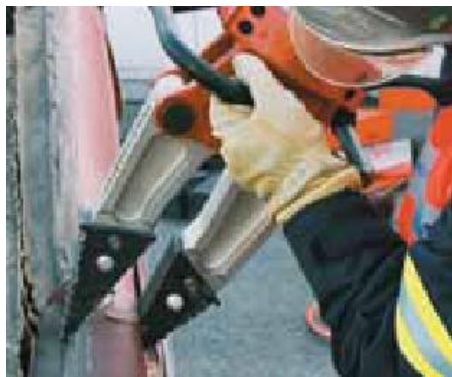
Figura 36. Compresión del riel del piso.
