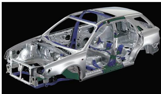
Figura 17. Constitución de un automóvil.
