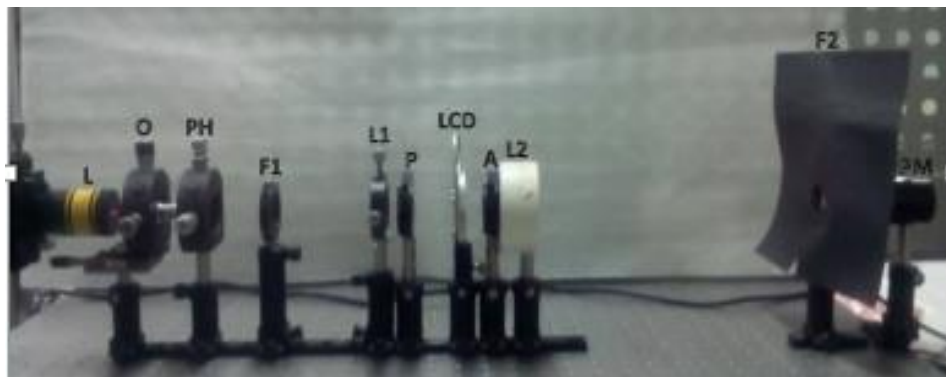
Figura 17. Montaje de laboratorio para registrar los datos obtenidos a través del método de Soutar-Lu. L, láser; O, objetivo; PH, pinhole; F1, apertura; L1, lente colimadora; P, polarizador; LCD, dispositivo de cristal líquido; A, analizador; L2, lente corregida de Fourier; F2, otra apertura y PM, medidor de potencia.
