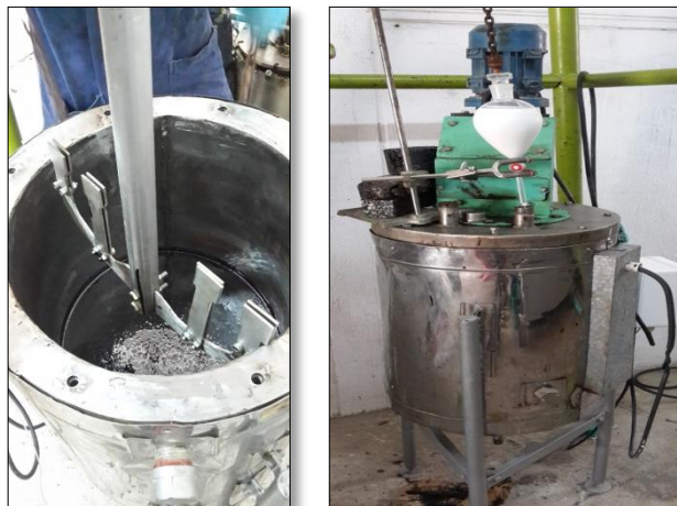
Figura 2. Reactor batch en donde se realizaron las modificaciones de los crudos pesados.
