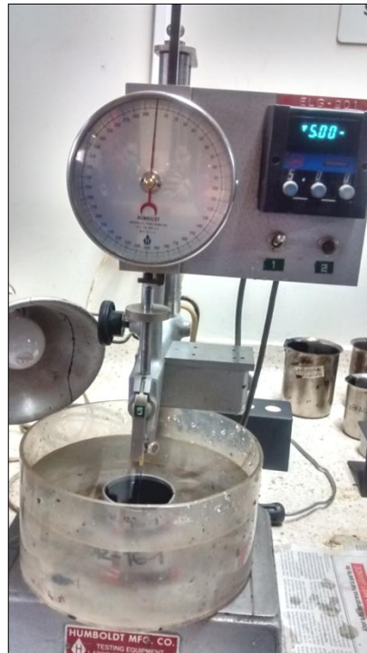
Figura 9. Montaje del ensayo de penetración.
