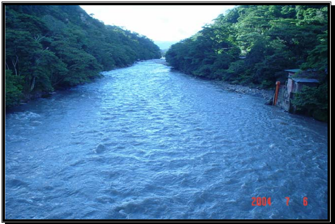
Fotografía 22. Sección de aforos en la estación Puente Yopal. El flujo mayor del río se encuentra recostado hacia la margen derecha.
