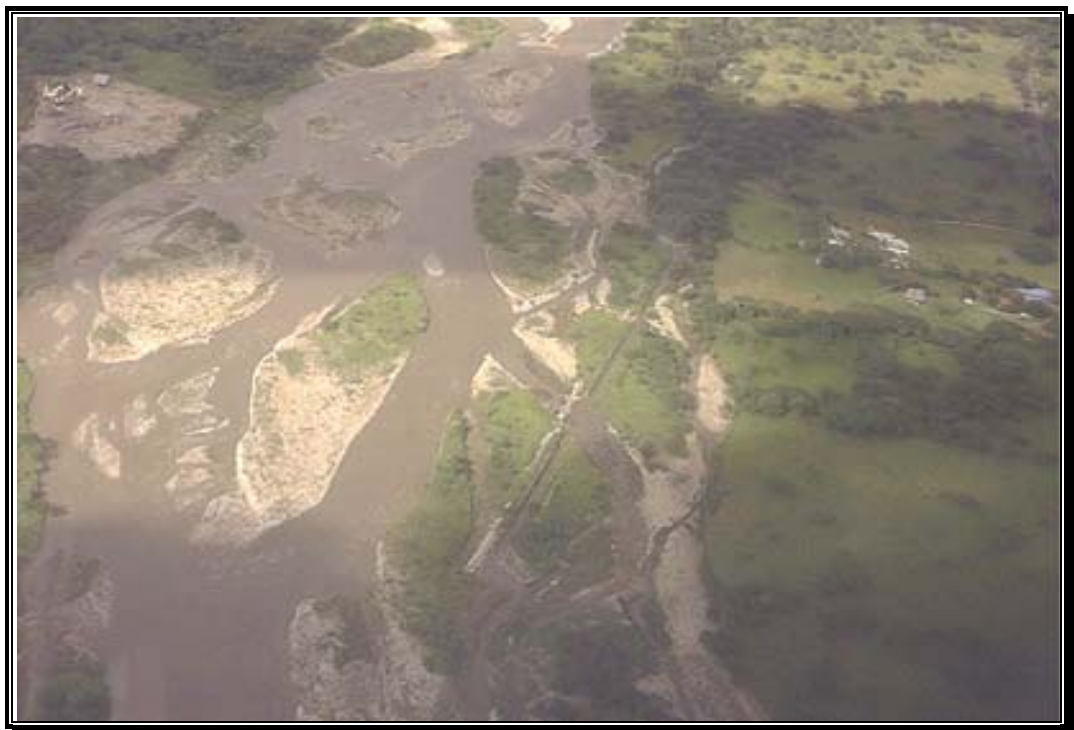
Fotografía 34. Trabajo de adecuación para derivar agua del río en las barras para el canal de Matepantano. La línea recta corresponde al canal dentro de las barras del río.
