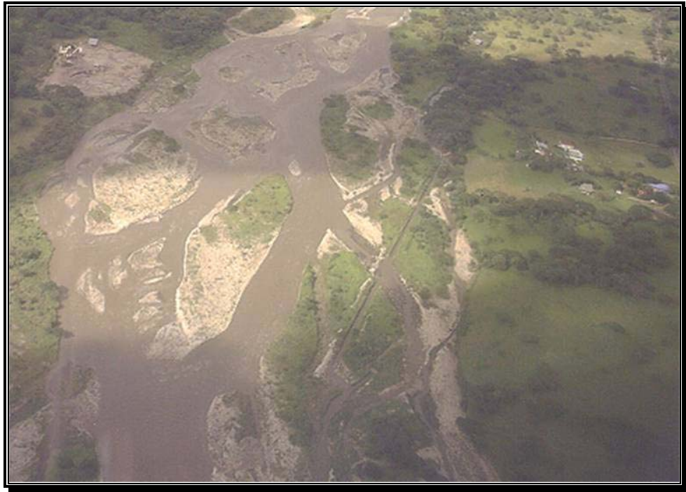
Fotografía 75. Canal recto a través de la barra No. 17 para llevar aguas a la bocatoma del canal de Matepantano.
