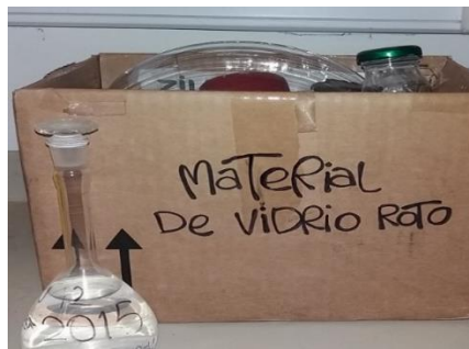
Figura 20. Caja almacenamiento de material de vidrio roto contaminado
