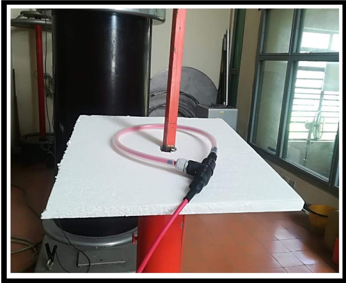
FIGURA 29: Ubicación de la bobina de rogowski en la base de la punta metálica
