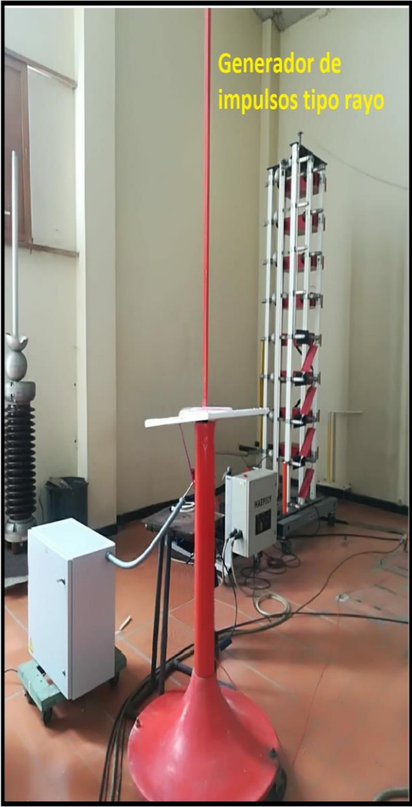
FIGURA 28: Arreglo punta-punta laboratorio alta tensión Universidad Industrial De Santander
