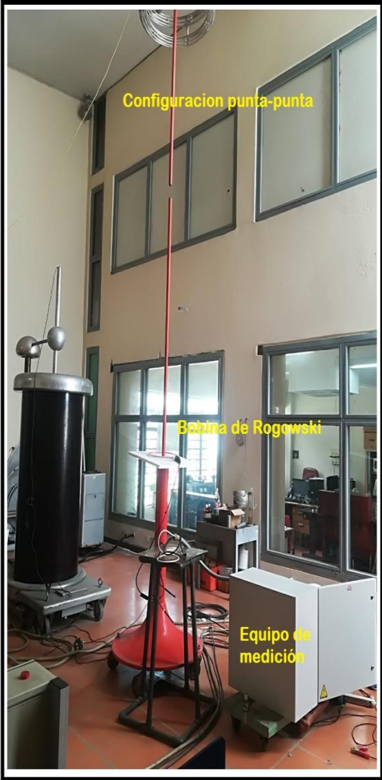
FIGURA 28: Arreglo punta-punta laboratorio alta tensión Universidad Industrial De Santander
