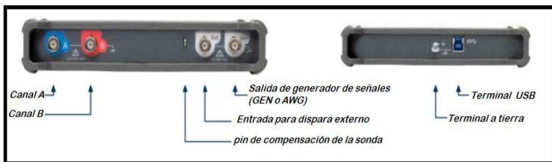
FIGURA 11: Diagrama de conectores del modelo de dos canales picoscope 3205D
