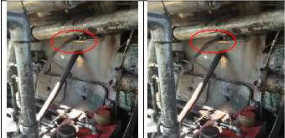
Se evidencia agua del sistema de refrigeración contaminada
