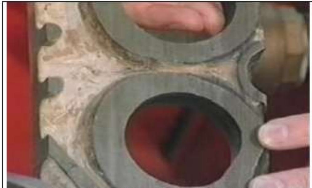
Incrustaciones gruesas debido a un tratamiento de agua inadecuado
