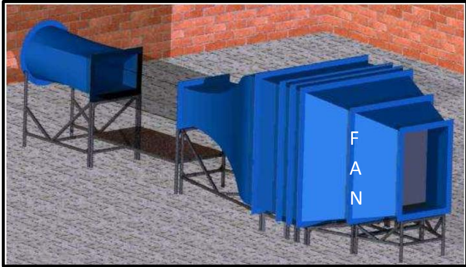
Figura 16 Túnel de viento circuito abierto, Soplador
