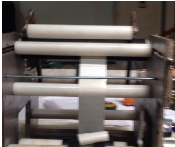
Figura 81. Tension y alineacion del rollo de papel
