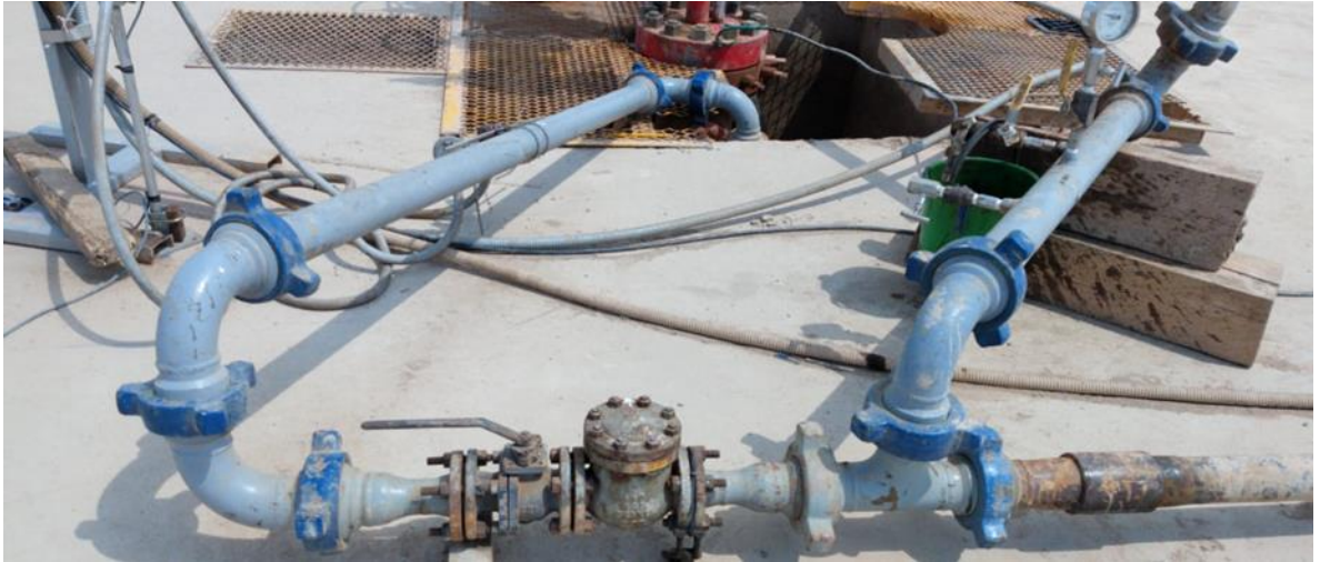
Figura 33. Líneas de trabajo Flushing
