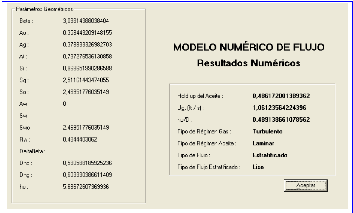
Figura 6.6: Resultados del modelo numérico de flujo para el campo RX dados por WAXSIM1.0 .
