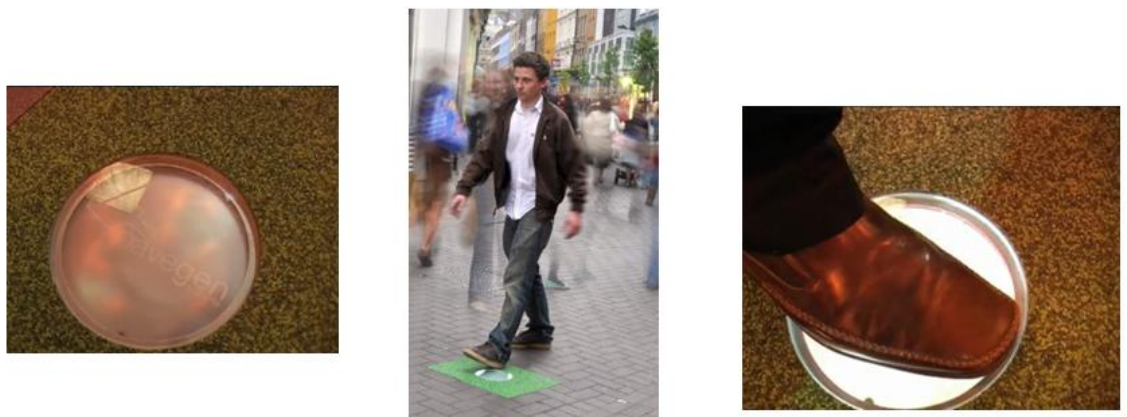
Figura 2. Dispositivo piezoeléctrico instalado en Londres por PavegenSystem
