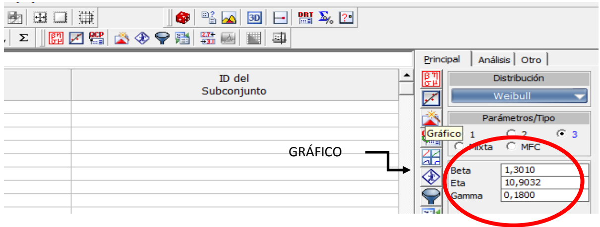
Figura 18. Proceso para calcular los parámetros de escala \alpha y forma \beta
