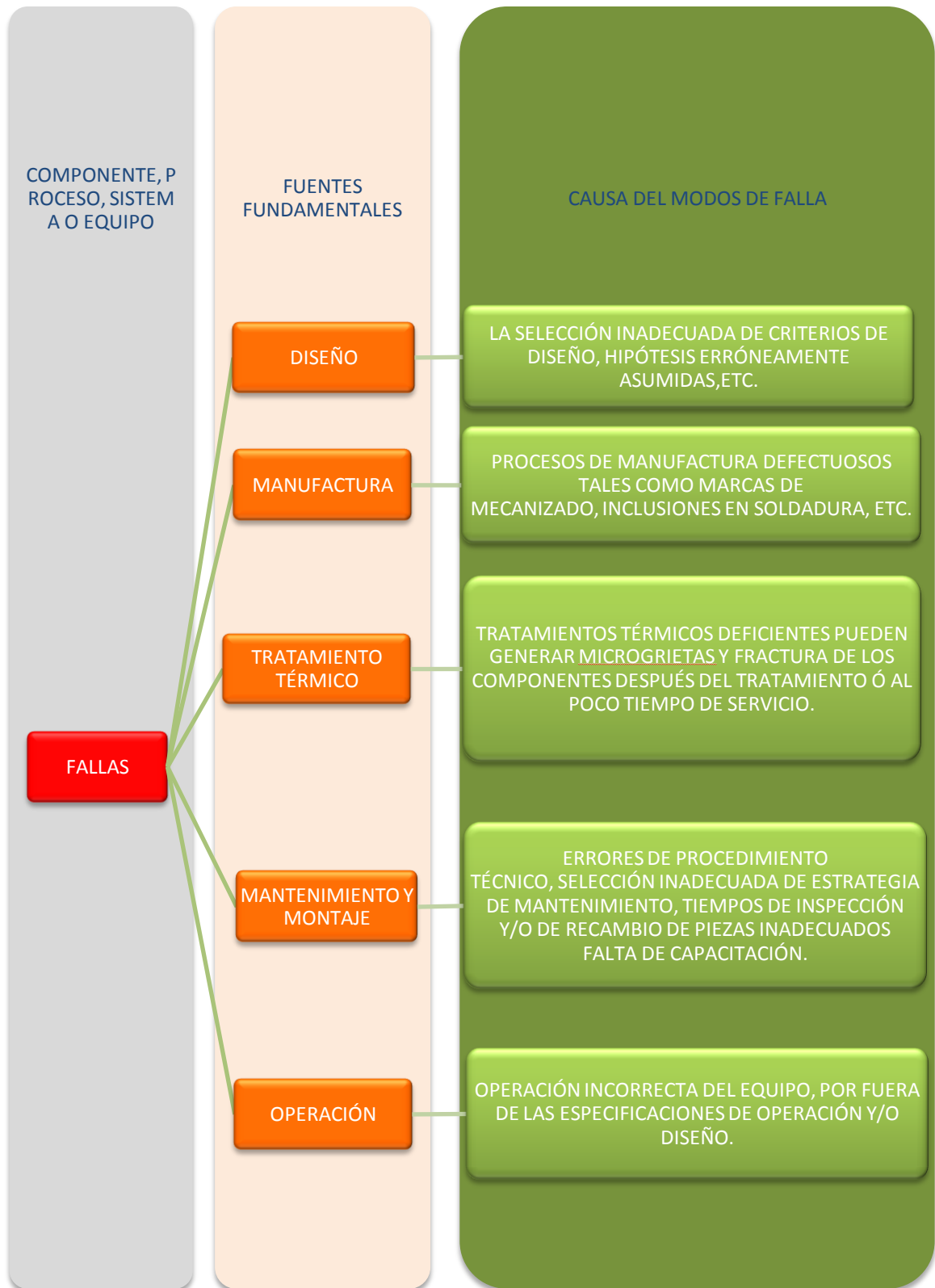
Figura 32. Fuentes fundamentales de falla
