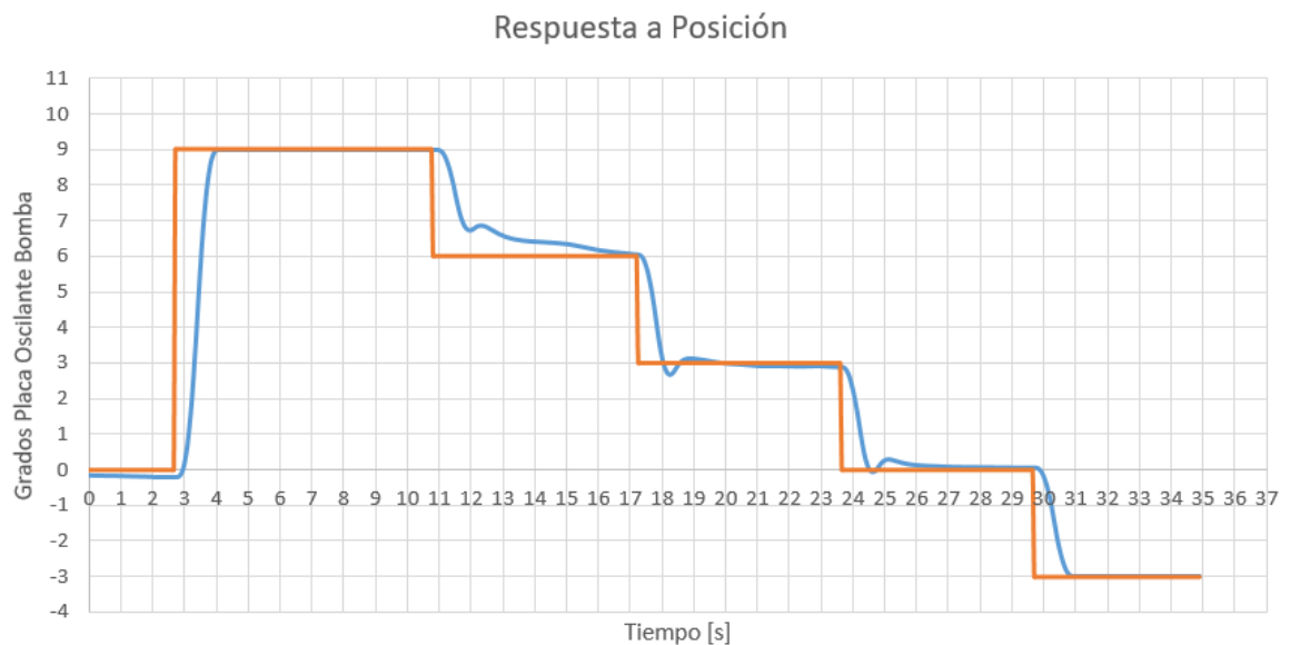
Figura 93. Respuesta de posición a valores de referencia
