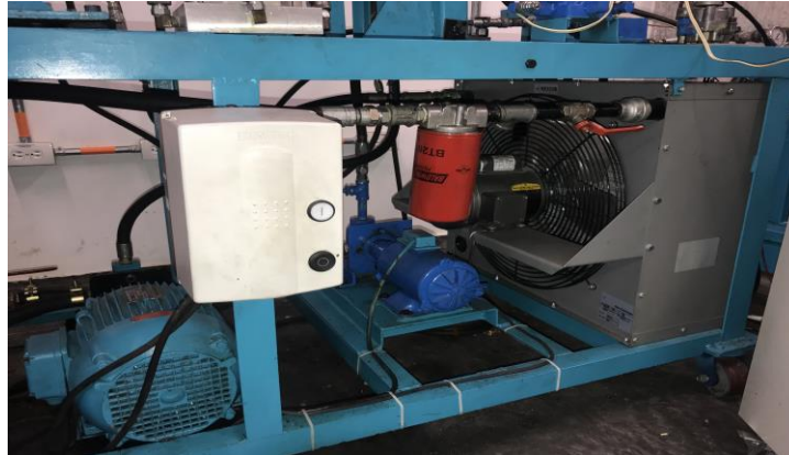
Figura 12. Sistema global de suministro y refrigeración.
