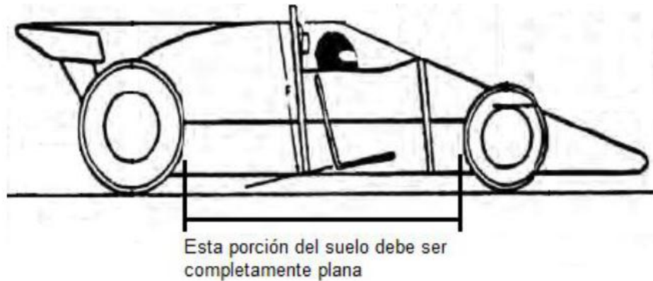
Figura 164. Especificación SENA del piso
