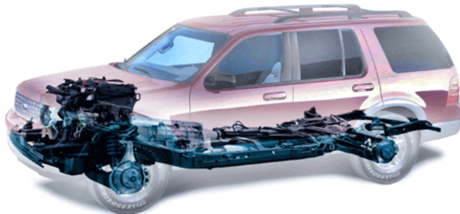
Figura 2. Carrocería y chasis separados
