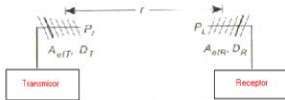
Figura 19. Balance de potencia entre dos antenas
