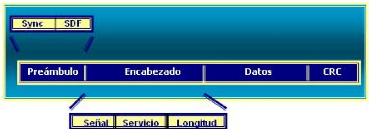
Figura 4. Formato general de la trama PLCP.
