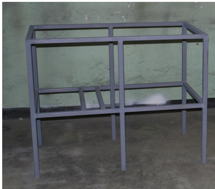
Figura 54. Estructura base de las cámaras de vacío
