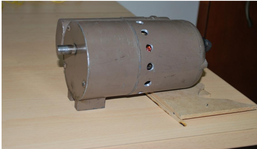
Figura 49. Moto-reductor de la banda de limpieza
