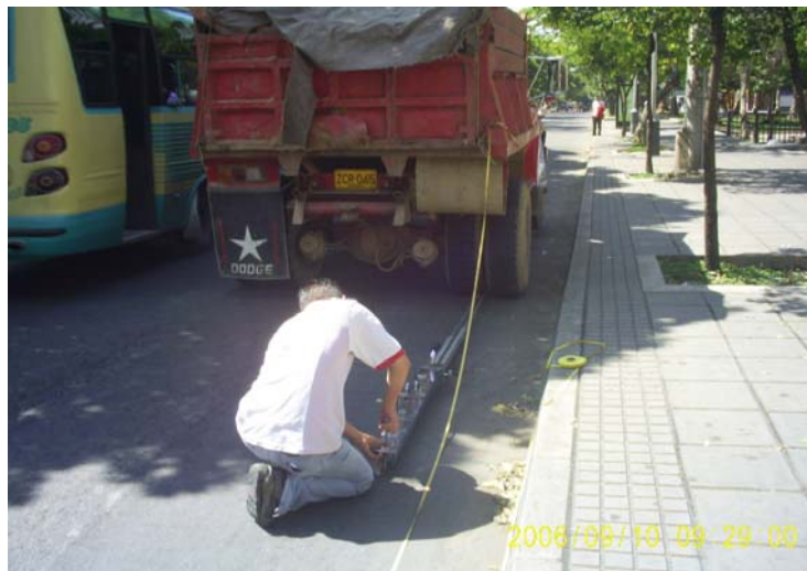
Figura 3. 7 Medición de la deflexión del pavimento con la viga Belkelman.
