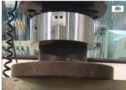
Rotula para aplicar carga vertical y horizontal simultáneamente.
