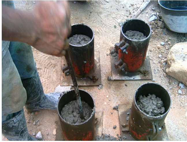
Foto 3 Elaboración de cilindros de concreto
