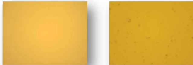
Figura 6. Micrografía de un cristal de cuarzo Au-Cr a 5X. Cristal de cuarzo sin recubrimiento, izquierda y cristal de cuarzo con recubrimiento, derecha.
