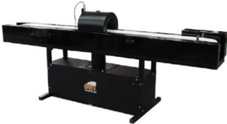
Figura 16. Equipo utilizado para la toma del core gamma ray.
