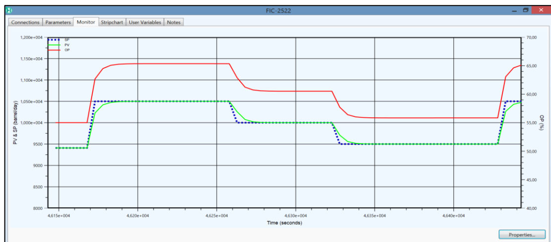
Figura 54. Respuesta controlador reflujo inferior con sintonía sugerida por hysys .
