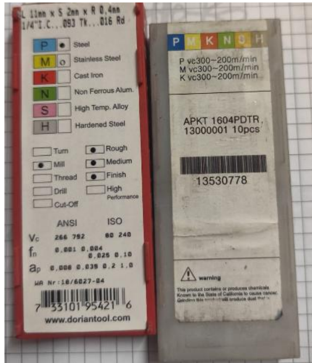
Figura de plaquita del código APKT 1604 para procesos de fresado.
