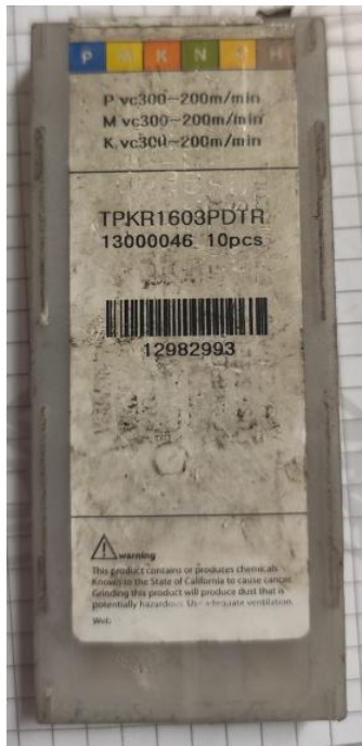
Figura de plaquita del código TPKR 1603 para procesos de torneado.
