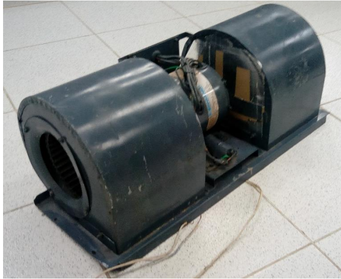
Figura 44. Sistema de impulsión de aire seleccionado.
