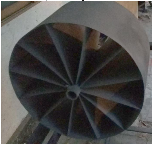
Figura 32. Elaboración del rotor para albergar el material desecante.
