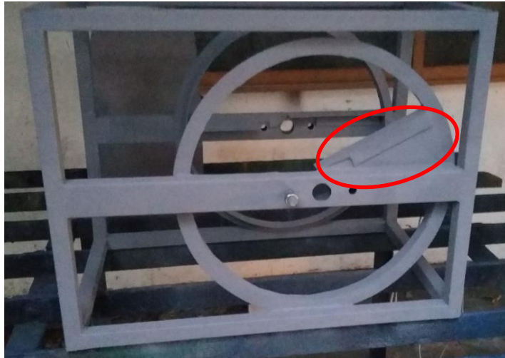
Figura 34. Parte fija de la rueda desecante, incluyendo la zona de sangrado .
