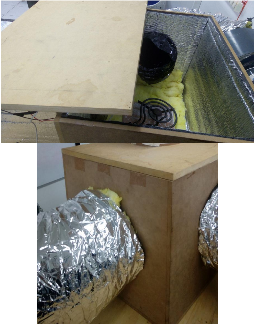
Figura 45. Caja utilizada como local a climatizar.
