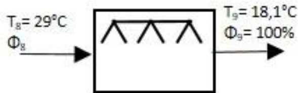
Figura 24. Esquema de la humidificación para obtener el efecto refrigerante del sistema.
