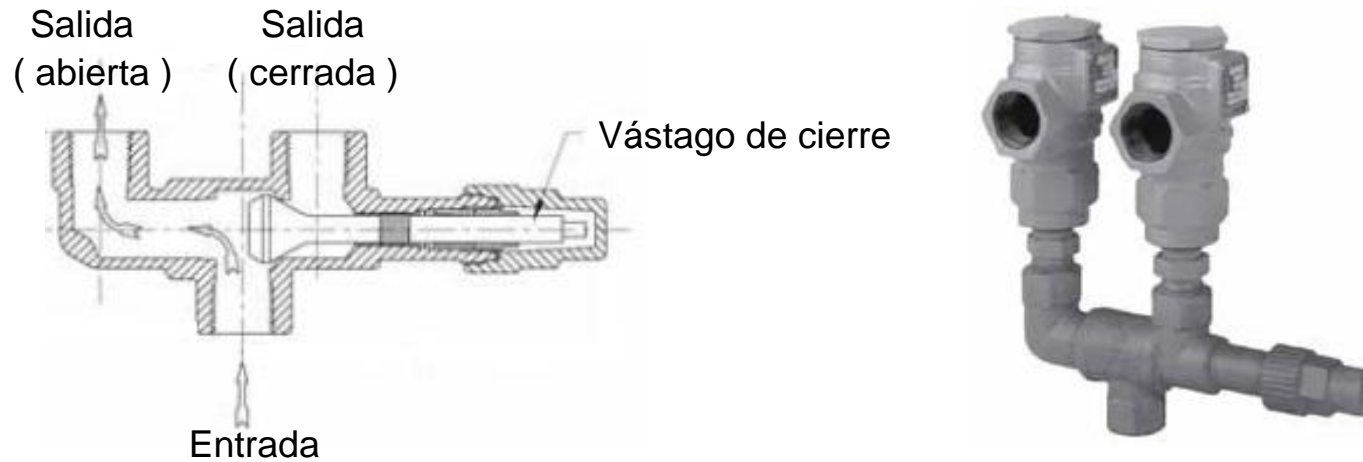
Figura 53. Disposición de válvula de seguridad doble H8021
