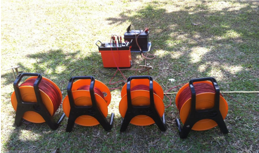
Figura 22. Equipo ABEM TERRAMETER SAS 1000/4000 utilizado para la adquisición de los SEV.
