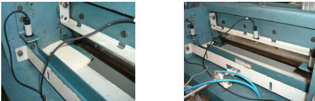
Figura 95. Estado final del sistema de alimentación de tiras.
