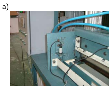
Figura 100. a) Detector para corte de tira dependiendo del tamaño a troquelar, sensor 3 o sensor 6.
