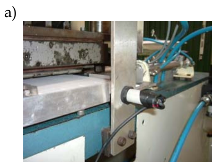
Figura 101. a) Detector de tira en troquel. b) Detección de tira en troquel.
