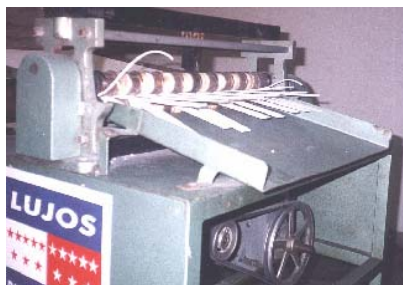
Figura 3. Corte longitudinal de tiras.
