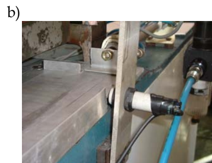
Figura 101. a) Detector de tira en troquel. b) Detección de tira en troquel.
