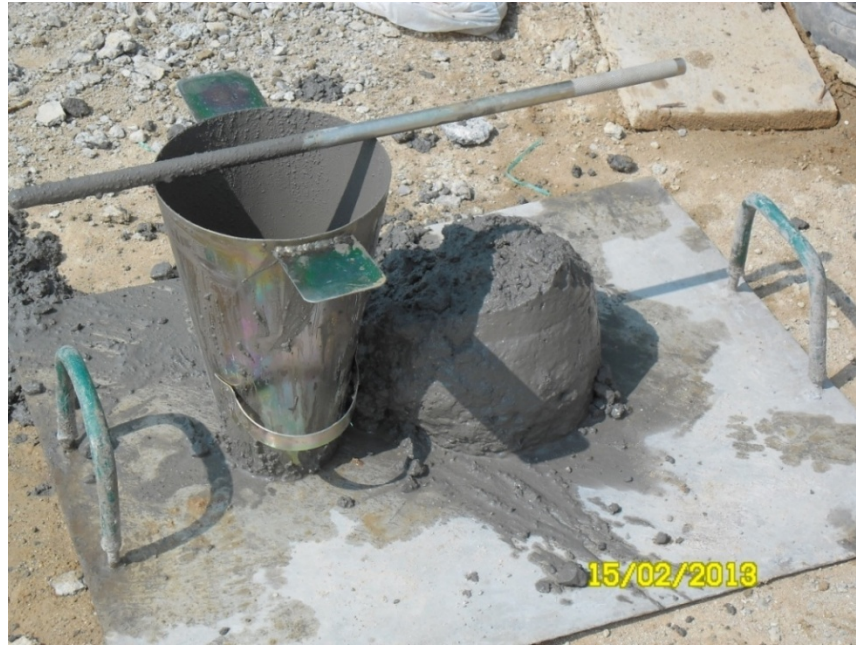
Ilustración 39. Toma de asentamiento de muestra de concreto. Fuente. El Autor.
