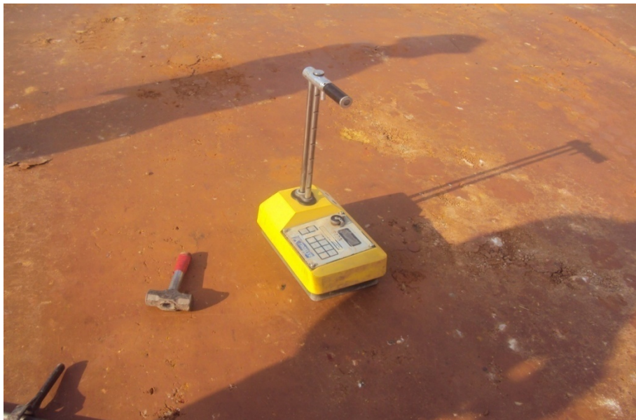
Ilustración 38. Densímetro Nuclear. Fuente. El Autor.
