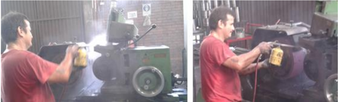
Figura 84. Procedimiento y herramientas para aplicar los líquidos para el lavado
