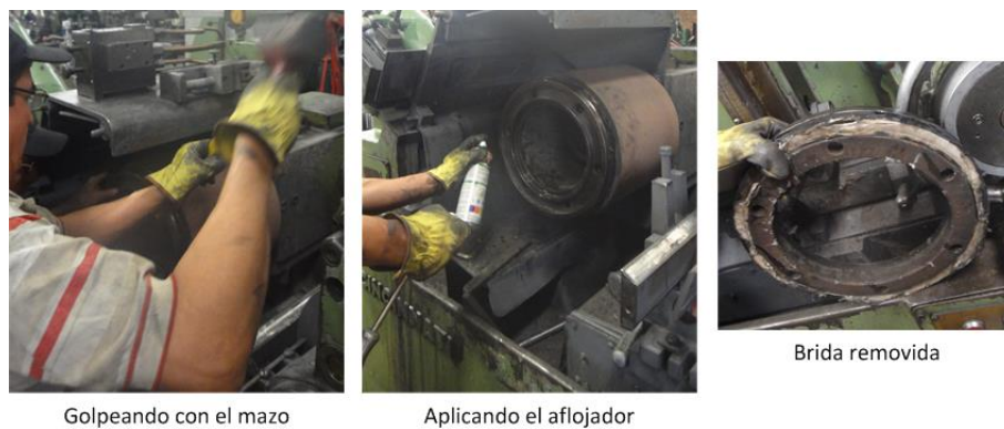
Figura 90. Procedimiento para remover la brida de sujeción de la piedra rectificadora
