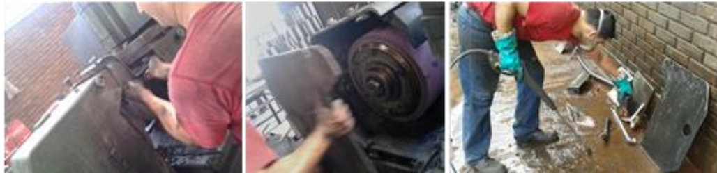
Figura 81. Procedimiento para el retiro y lavado de las guardas
