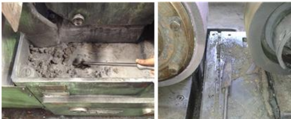
Figura 83. Procedimiento para retirar los sedimentos
