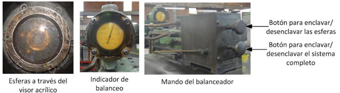
Figura 59. Sistema de balanceo de la piedra rectificadora
