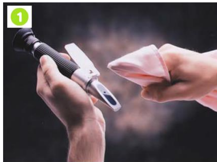
1 Limpieza del prisma con un paño limpio y suave
