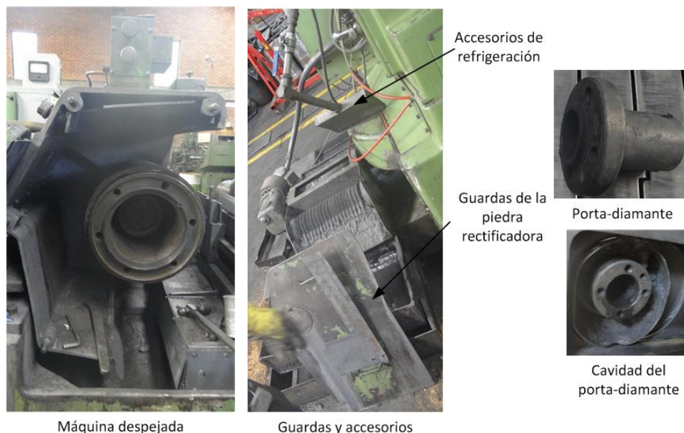
Figura 87. Desmontaje de las guardas y accesorios
