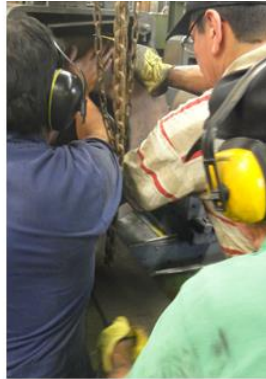
Operarios frontales acomodan la piedra. Operario trasero sujeta y retira la tabla.
