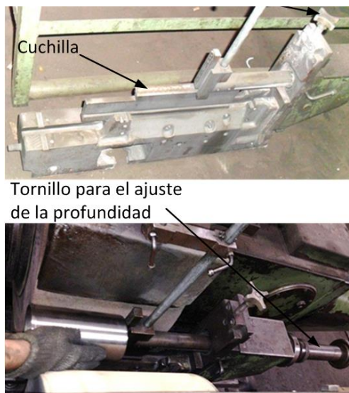
Figura 11. Reglilla para rectificado con avance restringido para piezas uniformes (Infeed)
