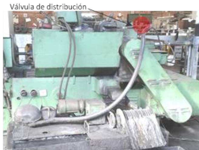
Figura 78. Ubicación de la válvula de distribución
