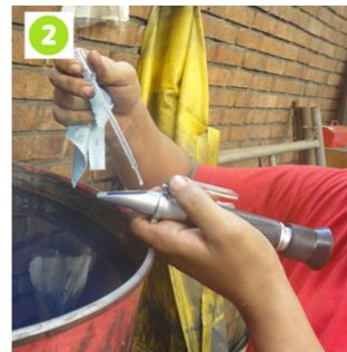
2 Colocar la muestra y cerrar la tapa
