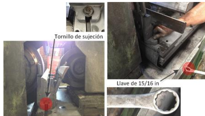
Figura 82. Procedimiento para el retiro de la reglilla
