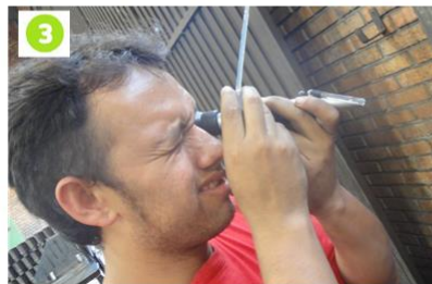
3 Observar la lectura horizontalmente y contraluz
