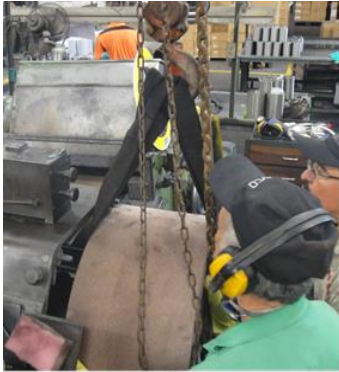
Operarios subiendo y acomodando la piedra
