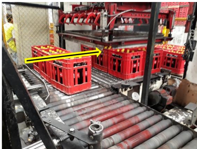
Figura 19. Cajas enfiladas y empujadas.
