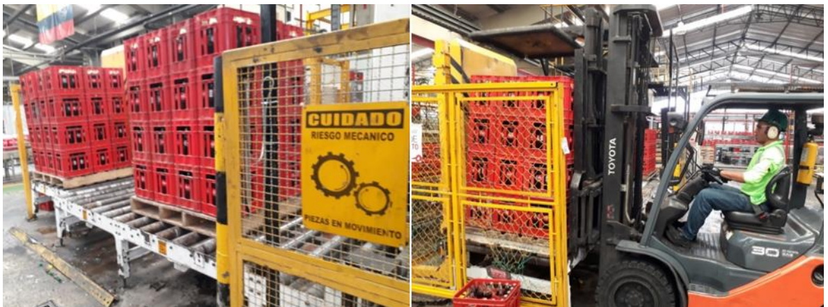
Figura 23. estibas armadas y recogidas por un montacarga
